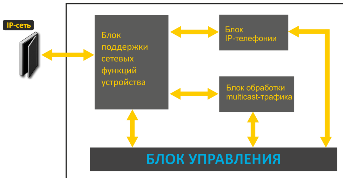
Рисунок 3 – Функциональная схема устройства серии TAU-2M.IP
